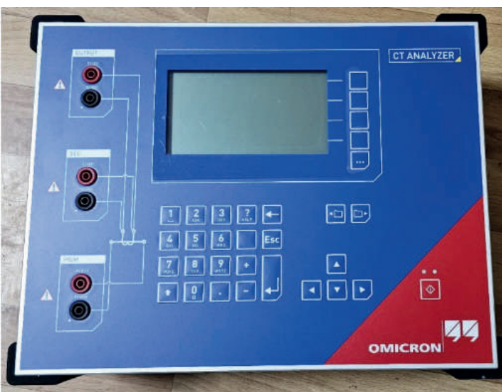
Стенд для проверки трансформаторов тока 6-500 кВ
