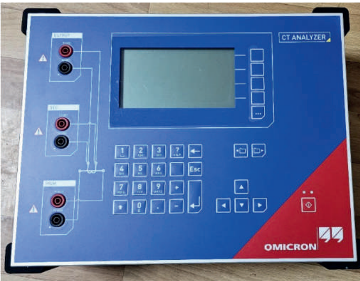
Стенд для проверки трансформаторов тока 6-500 кВ
